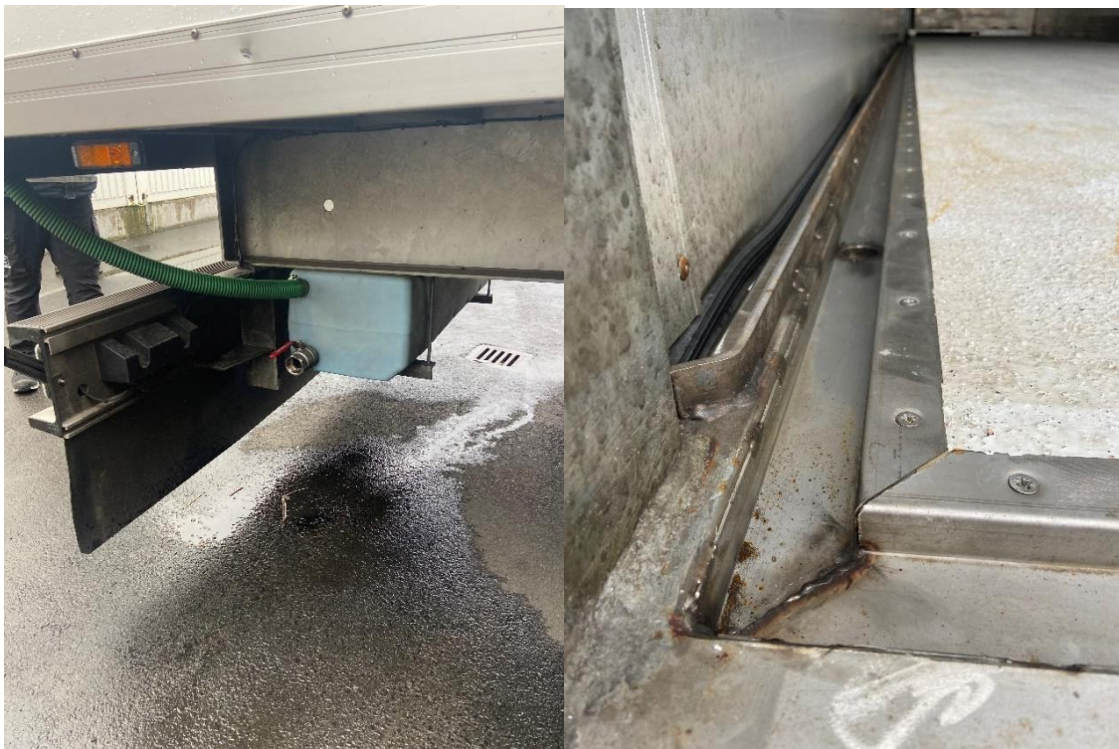
Bilde 1 Venstre: Oppsamlingstank for smeltevann på islandsk lastebil. Tanken er cirka 100 liter stor og er festet i rammen bak på tralla. Høyre: Renne og avløpshull for oppsamling av smeltevann ved transport av fersk fisk på Island sett fra bakenden av tralla (Foto: Bjørn Tore Rotabakk, Nofima)
