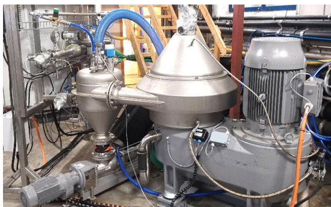
Bilde 1 Sentrifuge montert under fullskalatesting. Ventilrigg kan skimtes i venstre del av bilde. Slamoppsamler sees til venstre for selve sentrifugen, med skruerpumpemontert i underkant av denne.
