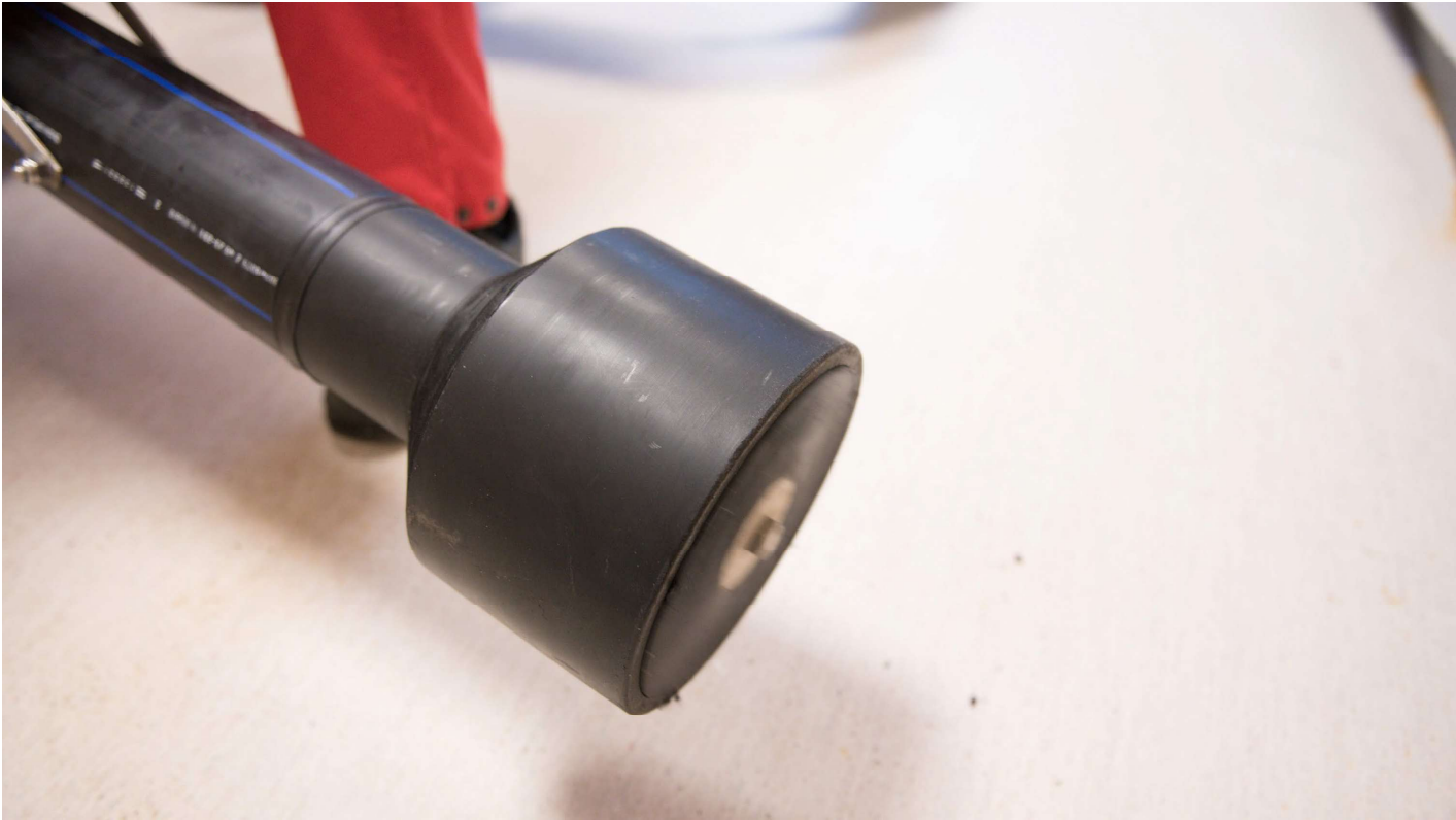
Med denne lydmaskinen ble det daglig spilt av svært høy lyd på hovedfrekvens 9 Hz for oppdrettslaks. Foto: Christine Fagerbakke / HI
