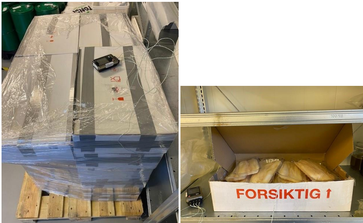
Figur 5: Figuren viser tining der etablert metode ble imitert. Sju kartonger ble stablet i fire tårn på en palle (til venstre i figuren). Tiningen foregikk på denne måten i to og et halvt døgn før eskene med fisk ble åpnet og tint i reol (til høyre i figuren).
