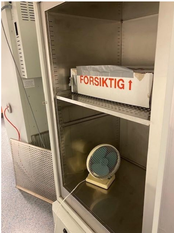
Figur 7: Figuren viser tineskapet benyttet i alternativ tinemetode
