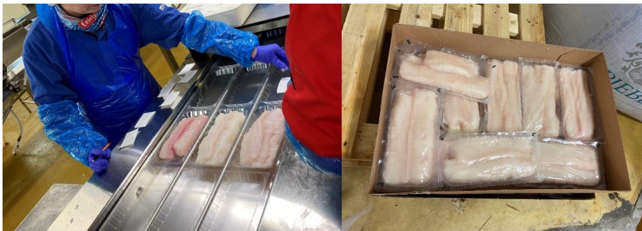
Figur 2: Figuren viser pakking av brosmeloinsene som inngikk i lagringsstudien. Til venstre i figuren, pakking i skinpack på dyptrekker og til høyre pakking av konsumentpakninger i esker før innfrysing
