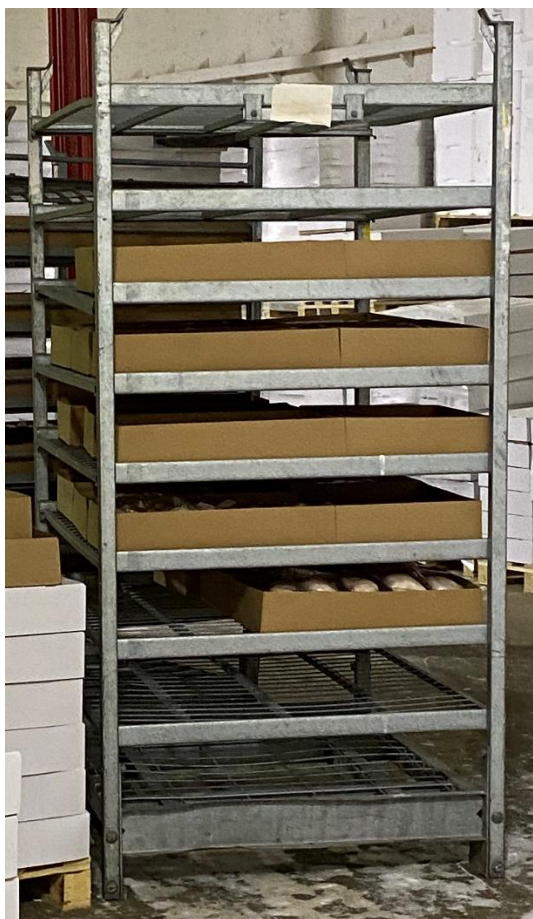
Figur 3: Figuren viser innfrysing av forbrukerpakningene i esker
