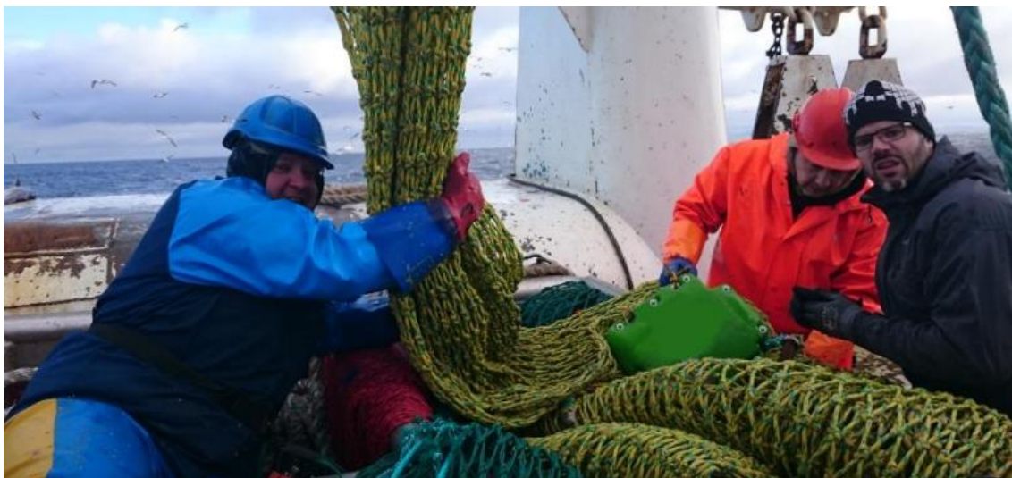
Figur 4-6: Bilde av at sekkeutløser, prototype II, er montert på sekken og klargjøres tatt under testtokt i 2017. Kilde: Havforskningsinstituttet/FHF, Delrapport Utvikling og erfaringer med sekkeåpner
