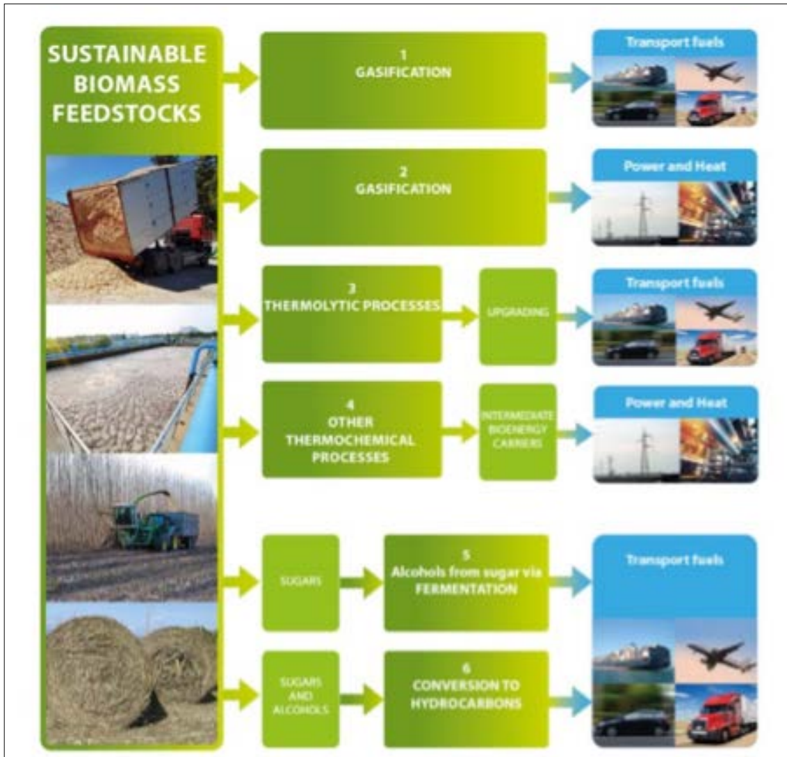
Figur 46 Figuren viser hvordan rester og avfall fra ulike biologiske opphav kan omdannes enten til alkohol, som kan erstatte bensin, eller til hydrokarboner, som erstatter diesel og jetfuel. Kilde European Technology Innovation Platform
