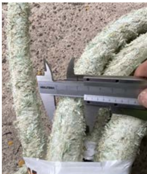
Bilde 2: Tverrsnittmålinger av brukte snurrevadttau fra Båtsfjord (Bilde: Jørgen Vollstad, SINTEF Ocean, 2020).
