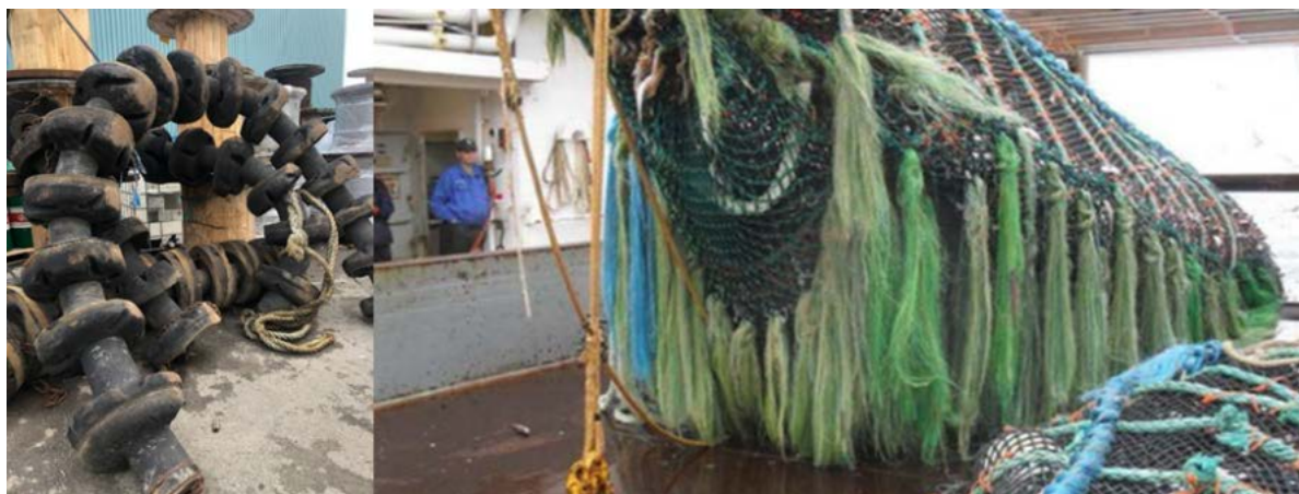
Bilde 3: Trålgear og slitematte med synlige slitasjetegn.
