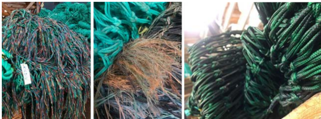
Bilde 4: Bilde av en ny (til venstre) og en slitt (i midten) labbetuss. Slitematte av impregnerert nylonnett (til høyre).
