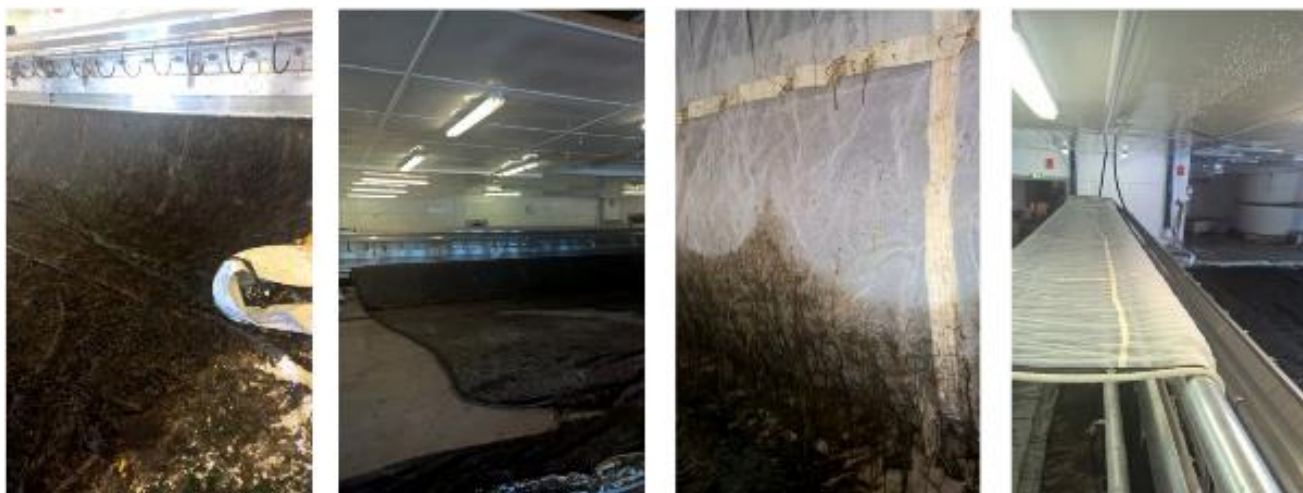
Figur 1: Vaskemaskin for luseskjørt med roterende dyser (Foto: Remi Mathisen, Nordlaks Oppdrett AS).
