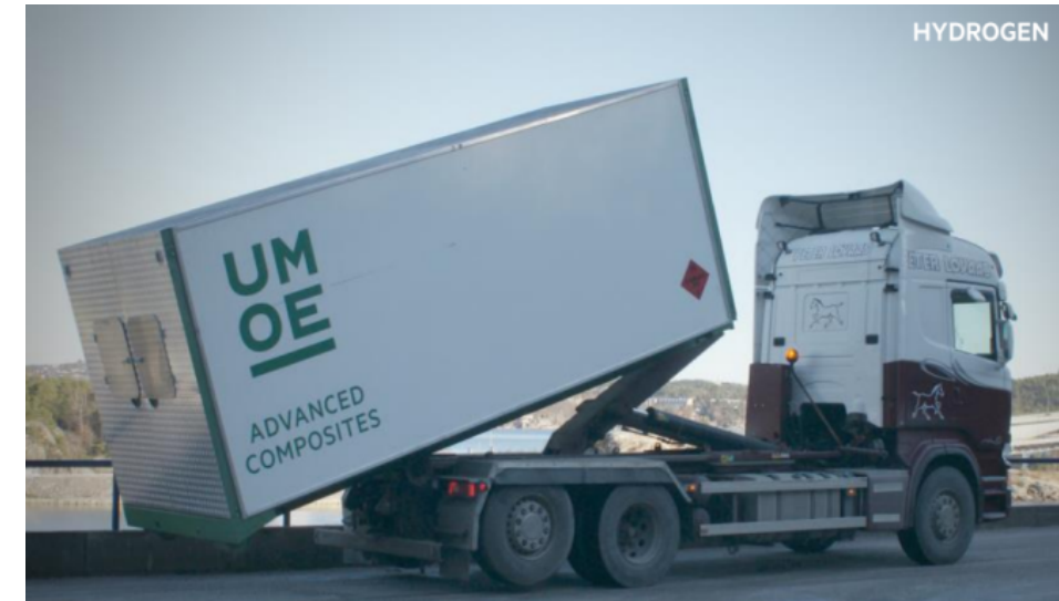
H 2 -tank/container 300 kg @ ~ 1,8 MNOK
