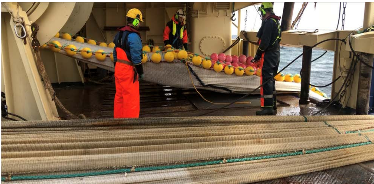
Figur 18: Bildet viser utsetting av dobbeltrål der vi sammenligner fangsten av en trål med en vanlig 1,8 m x 3,6 m seleksjonsrist mot fangsten av en trål med Excluder.
