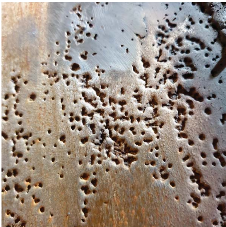
Figur 25. Korrosjonsangrep i Weldox-plater
