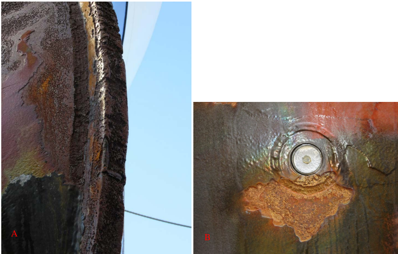
Figur 22. Korrosjon på skrog (A) nær sveis og (B): rundt ødelagt referanseelektrode
