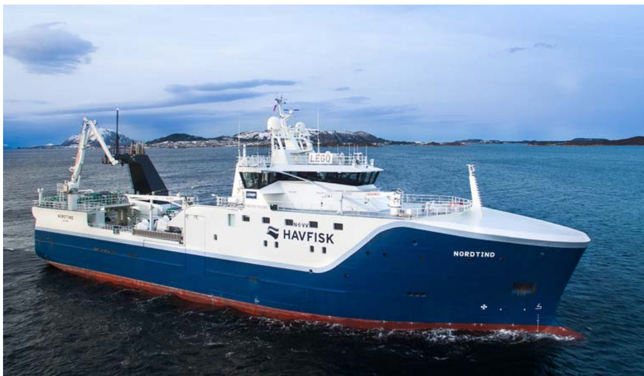
Figur 3-2 Hekkråleren NORDTIND som ble levert til HAVFISK i 2018 har en fartøyslengde på 80,4m loa og en bredde på 16,7m (Illustrasjon: Havfisk).
