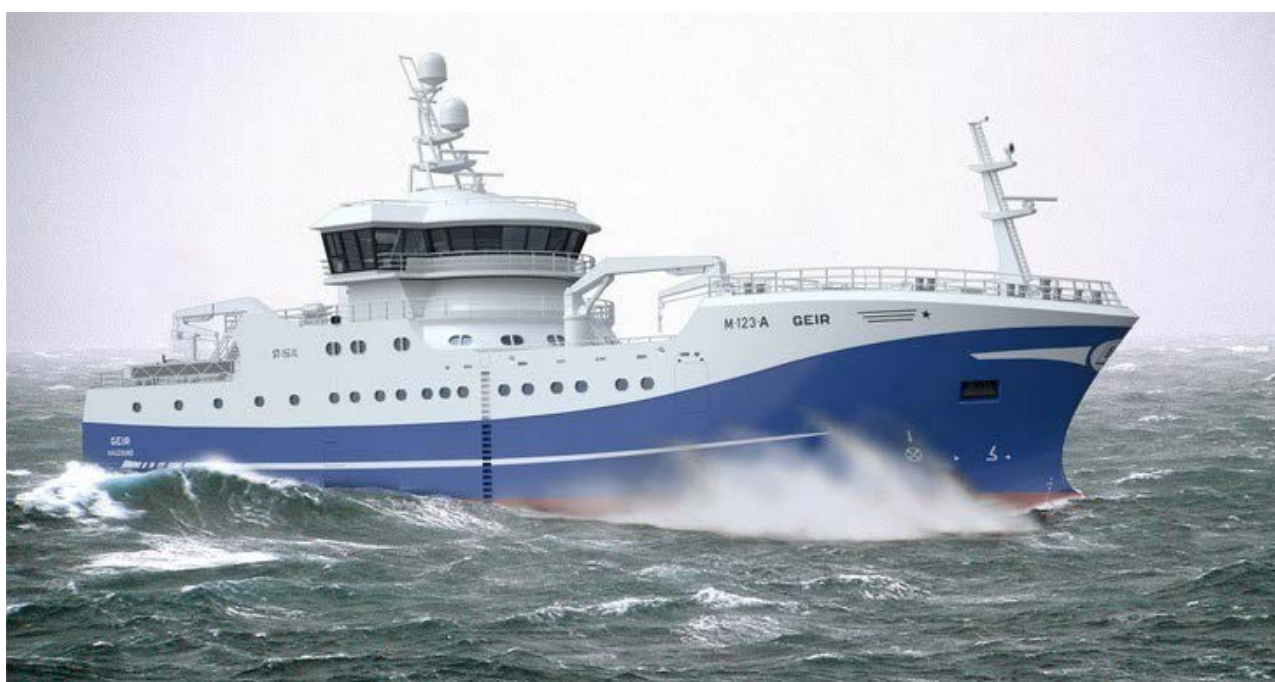
Figur 3-1 Nye «Geir» blir landets største linebåt når hun leveres i begynnelsen av 2020. Designen har typebetegnelse ST-156 XL med lengde 61,80 meter loa og 13,50 meter bredde (Illustrasjon: Skipsteknisk).
