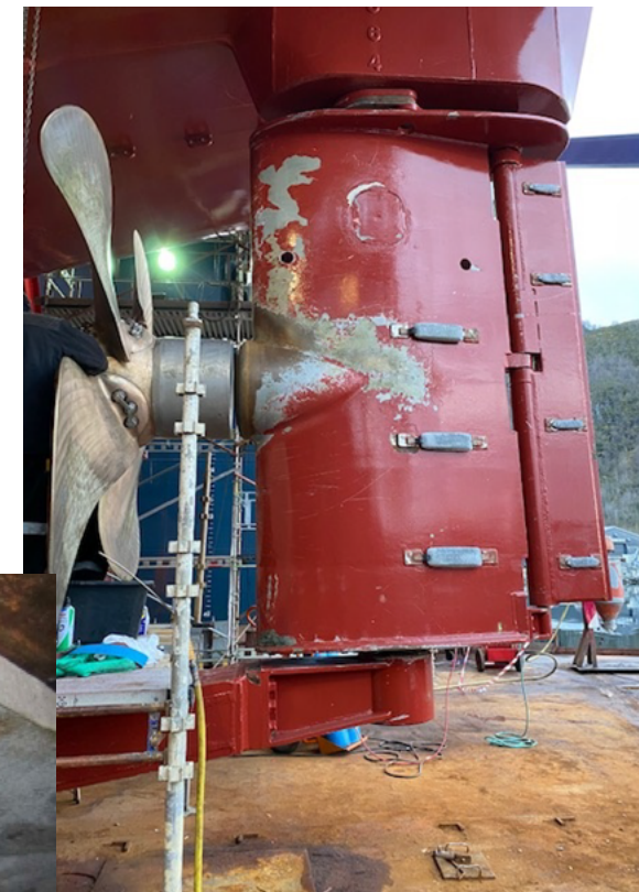
Plassering av anoder på ror
