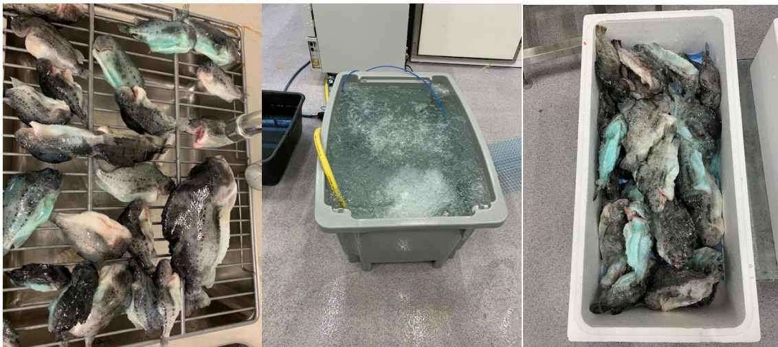
Figur 3 Bilder av Rognkjeks – singelfrysing (venstre), glasering med is og oksygen (midten), singelpakket i flyfraktkasser (høyre)
