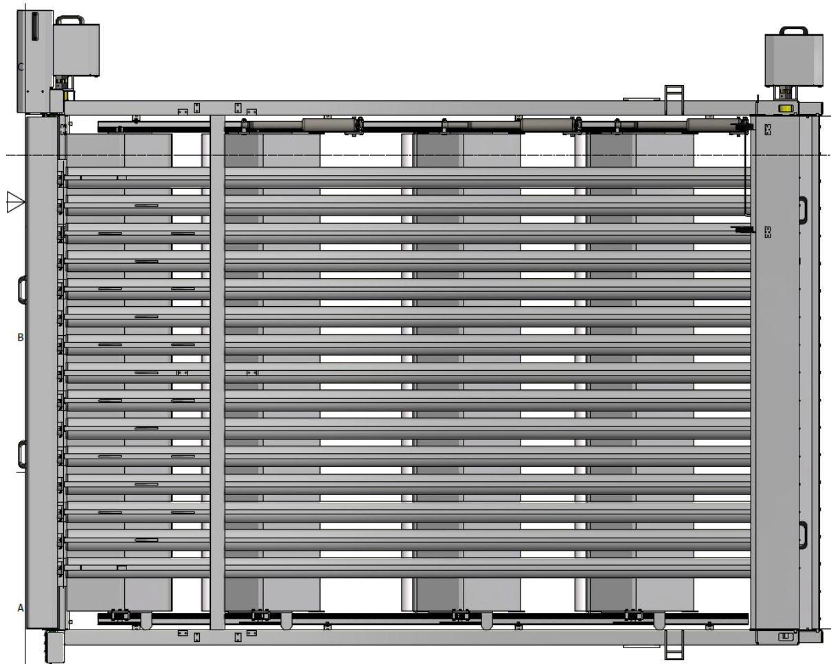
Figur 6. Rullesorteringsmaskin påmontert elektriske lineær-stempel for automatisert justering av mønetak.
