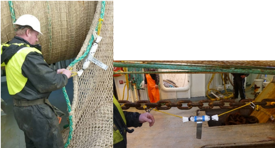
Figure 1. Montering dybdesensorer i trålen. Sensorene festet i notlin og på fiskelina ble bendslet fast med Spektra tau (venstre), mens sensorene i vingspissene ble montert med smettløgger (høyre) og tatt av før trålen ble spolet på nettrommel.
