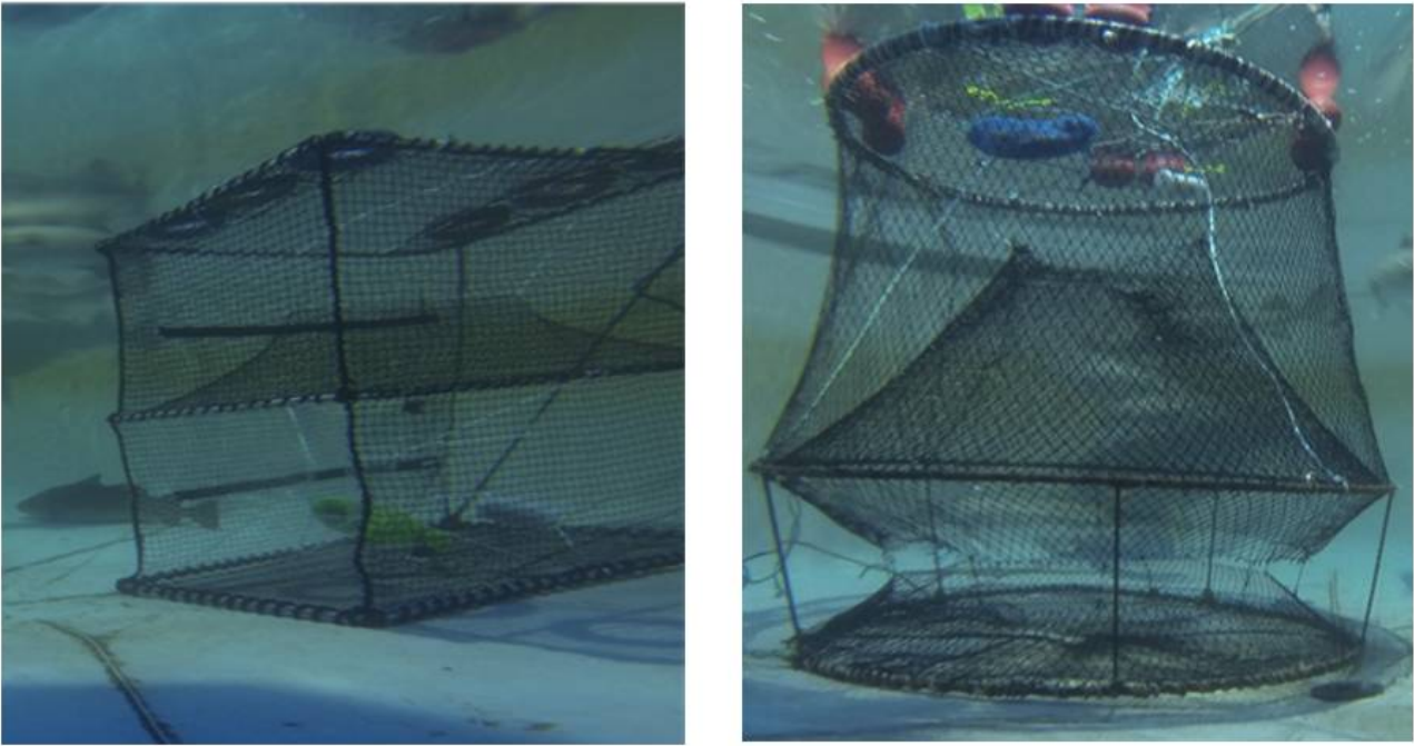
Figur 3.3.1. Venstre: Viser tradisjonell to-kammer torsketeine (Havteine/HT) Høyre: Viser referanseteinen av typen Innomar (IT).
