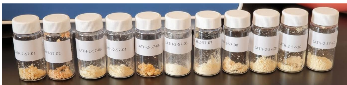
Figur 7 Bilde av frysetørkede lipideekstrakt oppnådd basert på betingelser i CCD. Nummerering av prøvene (LATH-2-57-##) angir forsøksnummer gitt i Tabell 7.
