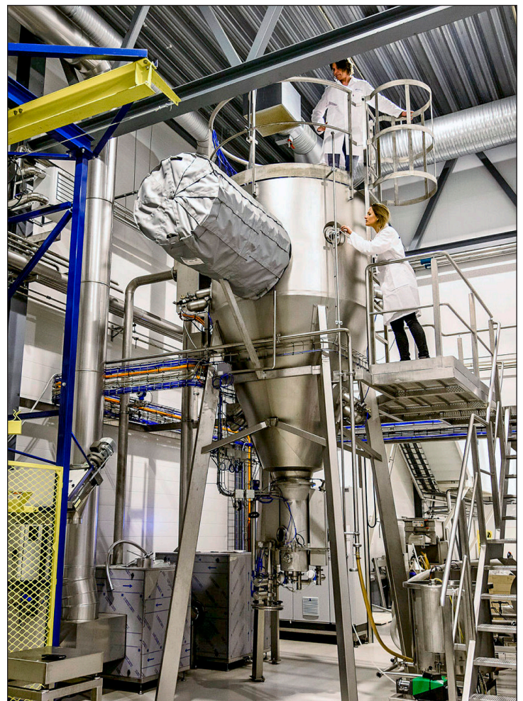
Spraytørke brukt i storskalaproduksjon av proteinpulver.
