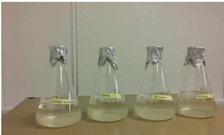
Figur 2: Bakteriekulturene ble tilsatt overført biofiltermateriale fra modnet RAS eller kommersielt inokulum. Kulturene inneholdt også sjøvann blandet med ferskvann til ønsket salinitet, ammonium, kilde til organisk materiale og rene biofilmbærere klare til kolonisering. Foto: Irene Roalkvam.
