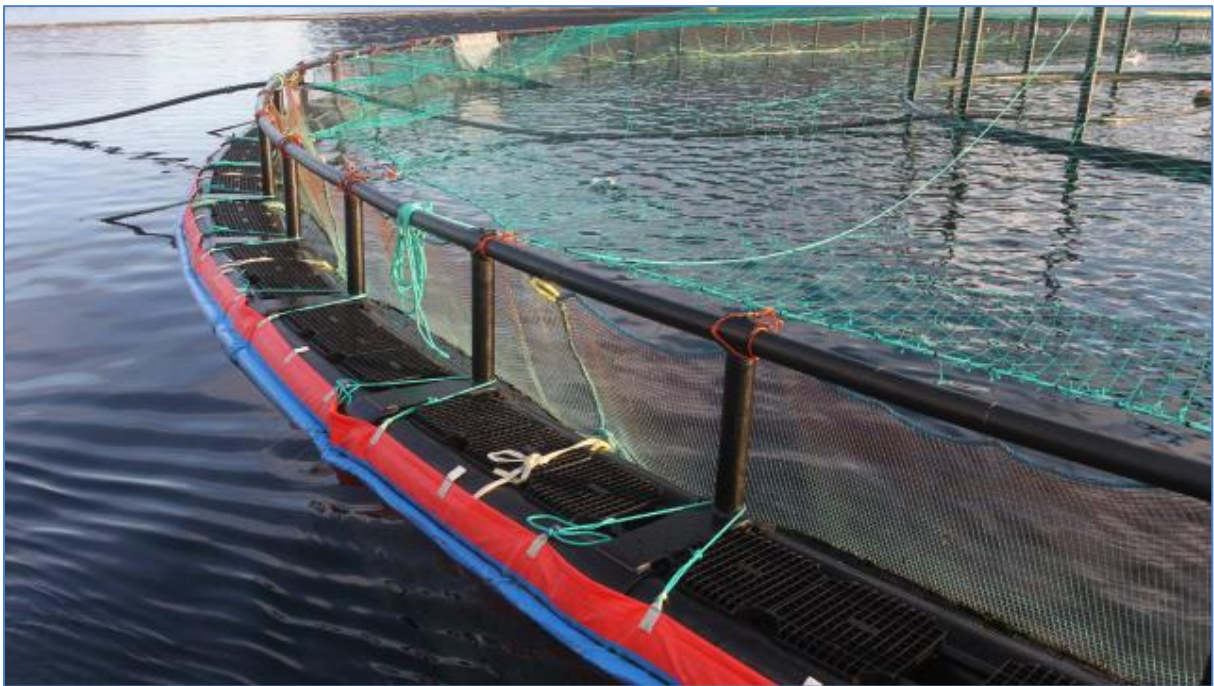
Figur 1. Ferskvannslense med innfesting og tilførselsrør ferskvann.
