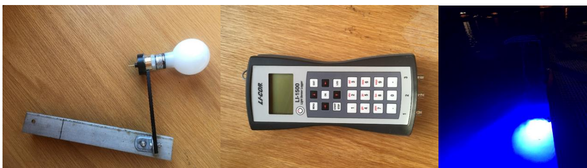
Figur III. Li-Cor SPQA 5242 sensor (venstre) og LI-1500 logger (midt) og lyskilde (440 nm) hengt opp og slått på 27. februar, kveld (høyre)
