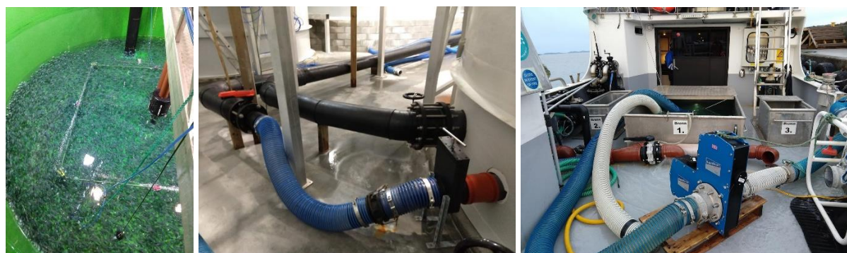
Første trinn i fisketransporten, overføring fra kar til brønnbåt: nedtapping av kar (trenging) og transport av fisk i rør fra kar til brønnbåt via fisketeller.
