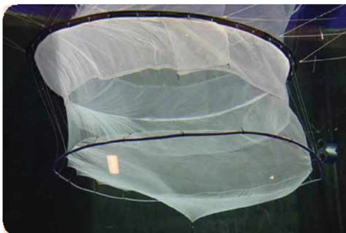
Modell i skala 1:17 av en 160-metring med sylindernot og 10 m dyptskjørt i planktonduk utsatt for strøm tilsvarende 41 cm/s i full skala.
