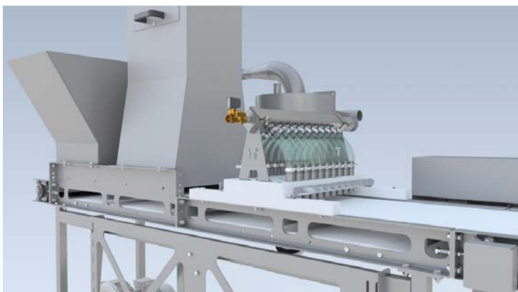
Figur 5: Dyser som suger opp underliggende partikler.
