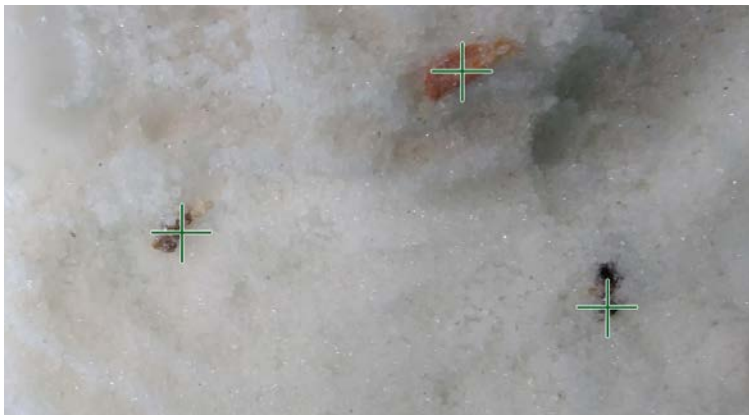
Figur 4: Automatisk deteksjon av uønskede partikler.
