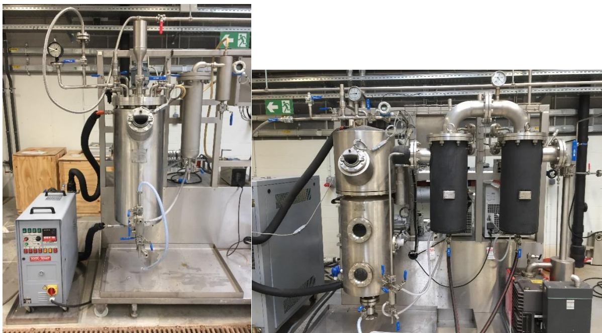
Figur 3 Pilotskala anlegg for raffinering av olje ved TERRA Teaching and Research Centre, Gembloux Agro-Bio Tech. Til venstre: reaktor for avsyring og bleking. Til høyre: deodorisator
