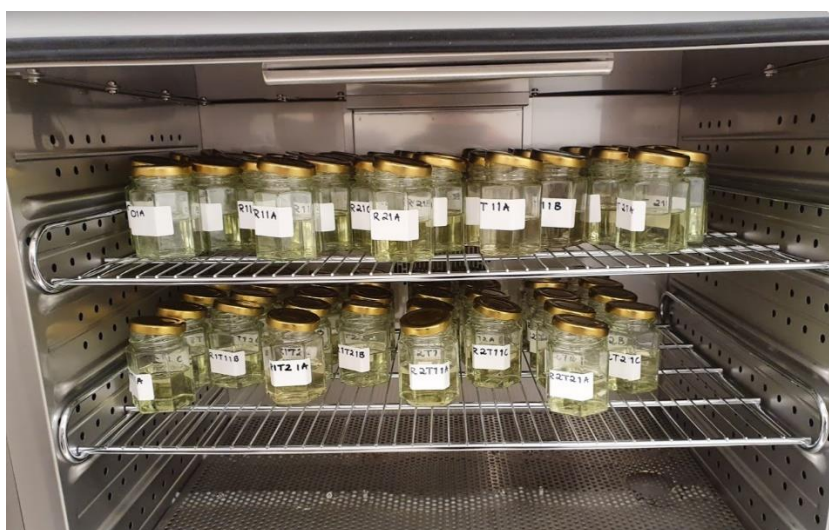
Figur 6 Akselerert lagringsforsøk av oljeprøver i varmeskap
