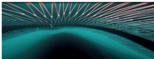
Figur 3: Overgangen fra de første store (400mm) maskene til første småmasket-seksjon ("bleie") viste at bleiene hang fint over de ytre store maskene. De store 400mm maskene hadde en åpning på ca. 17-20 %, som var en indikasjon på at trålens åpningsareal ikke var fullt oppnådd.
