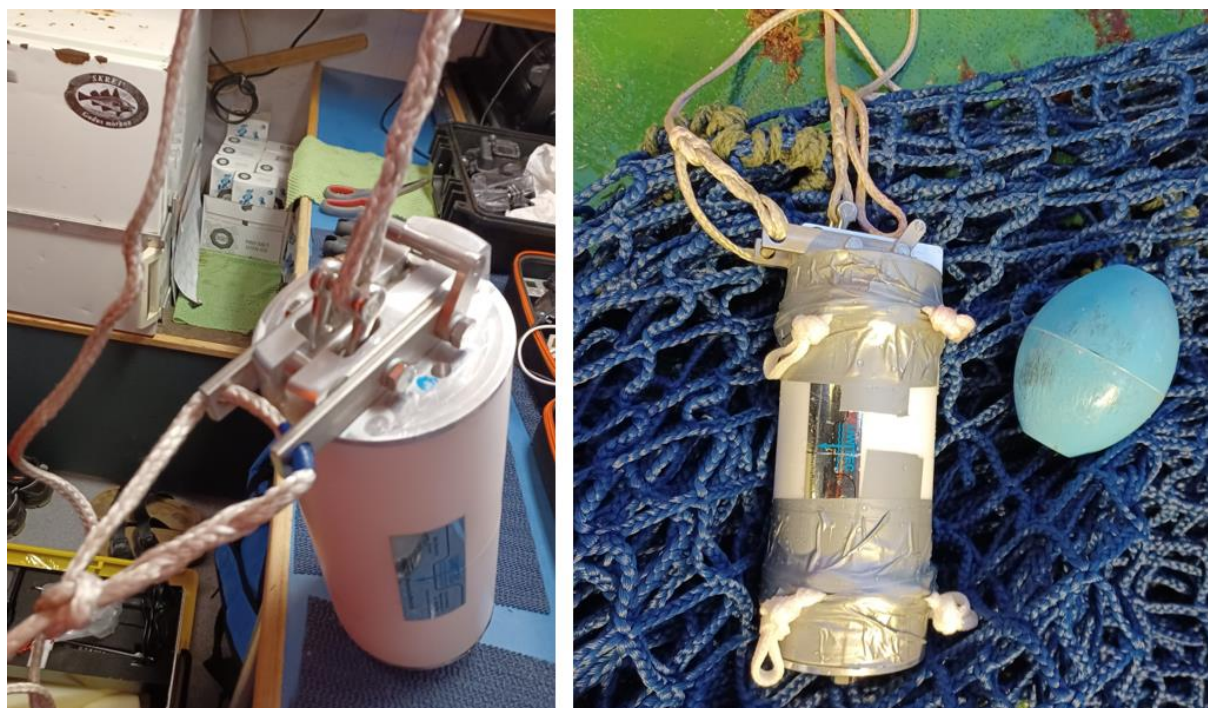
Figur 9. Uwitec utløseren etter modifisering. Til venstre ser vi hvordan gropen for utløserjakkel har vært forstørret slik at den kan trekkes sideveis. Til høyre ser vi improviserte «festeører», hvor taustropper er tapet på med lerretstape.
