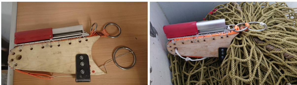
Figur 2. Første prototype utløser fra Stenevik produktutvikling. Til venstre ser vi utløseren før montering, den største ringen festes på tau/stropp som går rundt strekken og holdes på plass med den mellomstore ringen. Det samme blir deretter gjort med den minste ringen som festes i utløserkroken. Dette er gjort for å redusere belastningen på selve kroken slik at det kreves lite kraft for å åpne overknyttingen på sekken.
