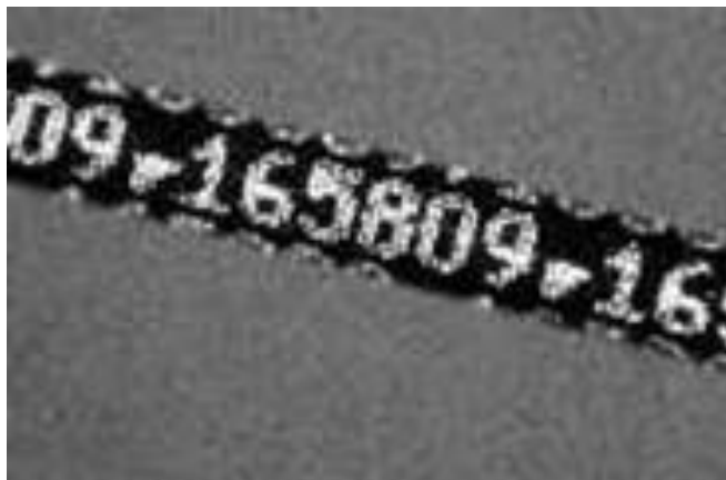
Figur 6 CWT merket har koder for inntil 10 000 grupper (Foto NMT)
