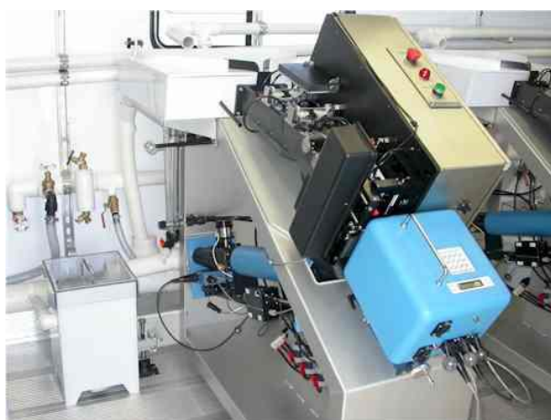
Figur 8 AutoFish system; merking med CWT + fettfinneklipping (Figur NMT)
