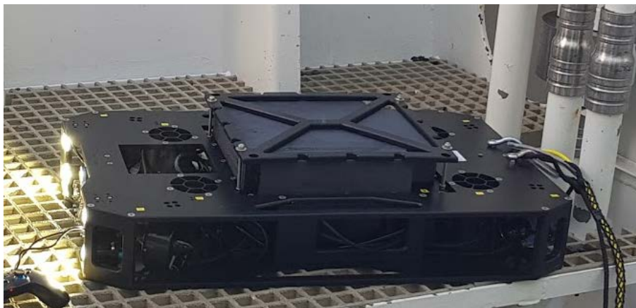
Figur 7. «FishBot 2» ROV-plattform for stereokamerasystem. (Bilde: Mohn Technology AS)
