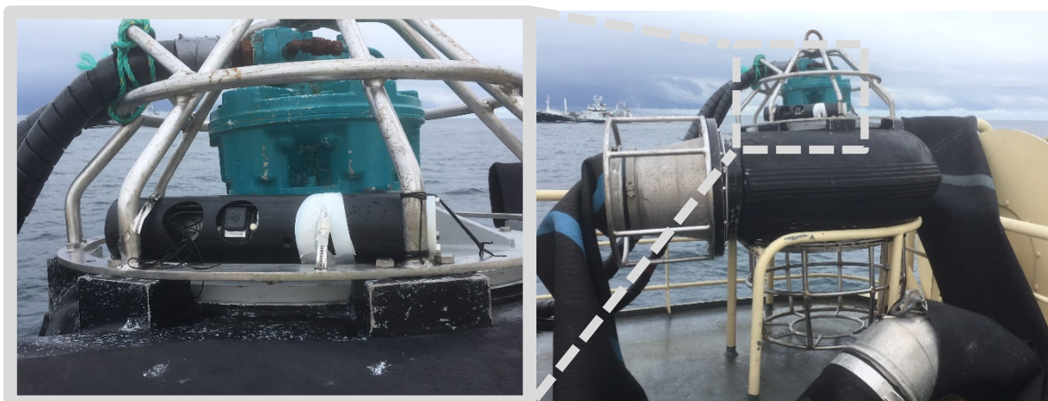
Figur 3. Fangstovervåkningssonden (CMP-pump) montert på fiskepumpen
