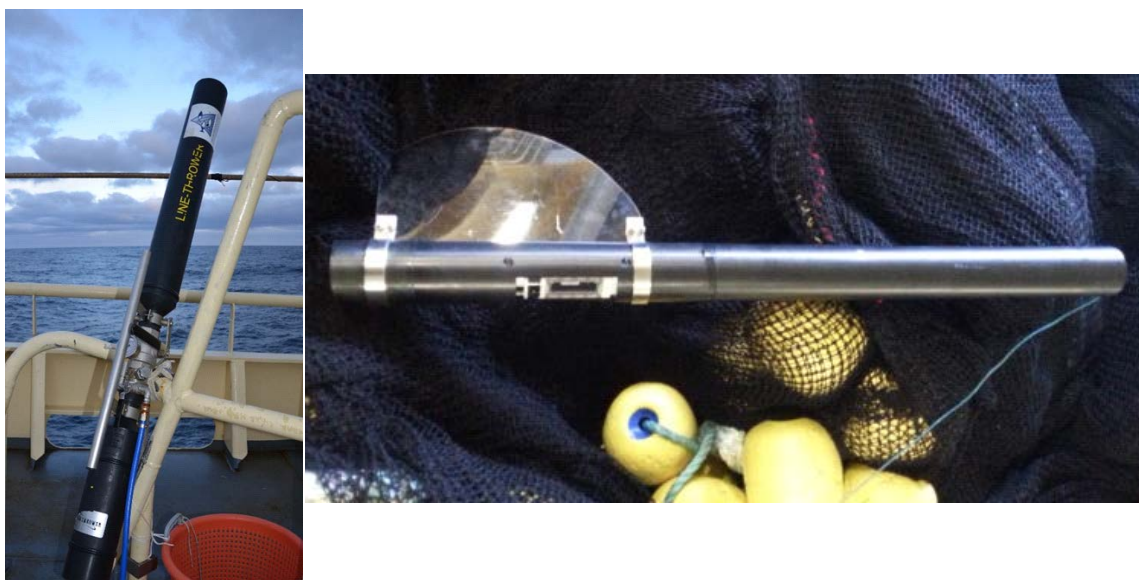
Figur 2. Fangstovervåkningssonden (CMP) i beskyttende hus (høyre) forberedt for utplassering fra en trykkluftkanon (venstre).
