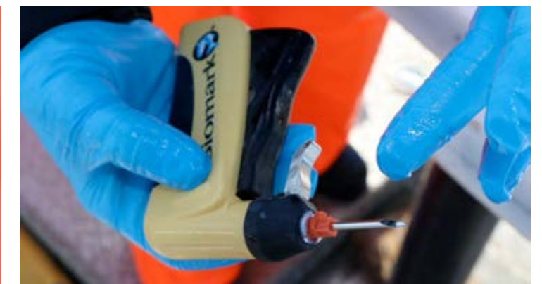
AMPULLE: Inni denne spissen av denne kanylen kan en bitte, liten glassampulle skimtes, en såkalt "Pit-tag". Kanylspissen er skradd, for å oppnå en så skånsom merking som mulig.
