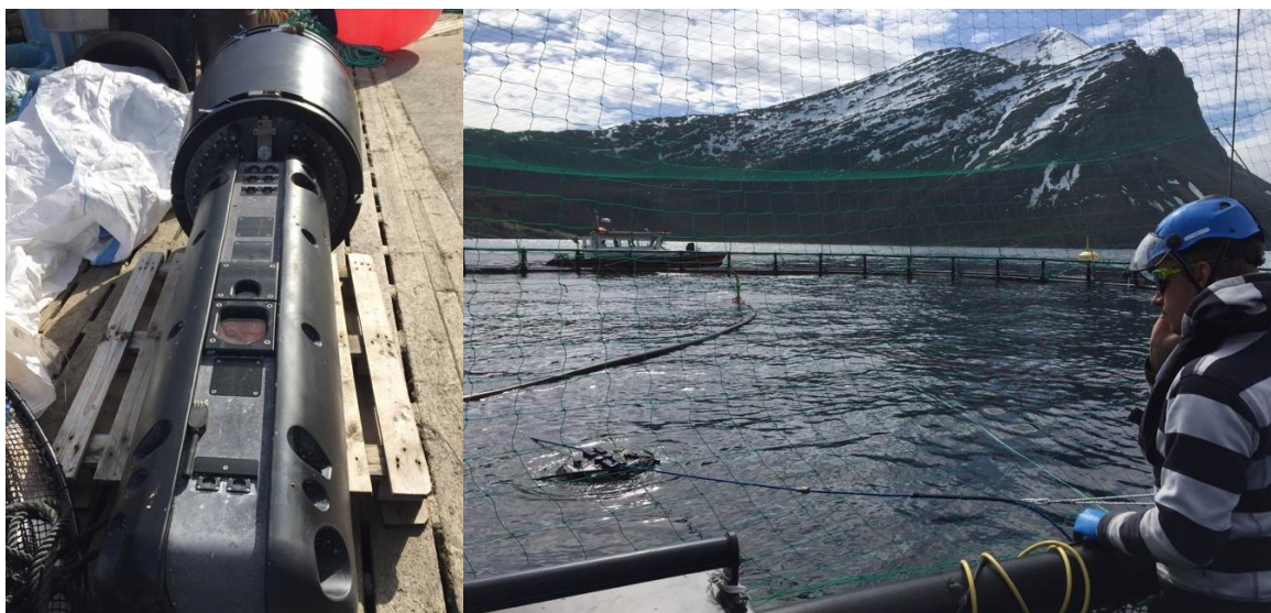
Figur 18 Laser oppe av vannet for vedlikehold (til venstre) og laser i bruk ved Kleiva fiskefarm til høyre
