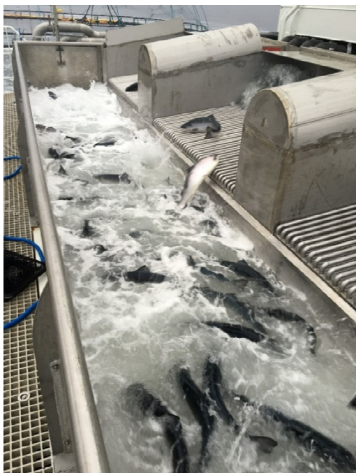
Figur 12 – Posisjon 2 : Etter å ha passert avlusingsenhetene og de hydrauliske fiskepumpene (Hydrolicer LG9332 Hydro) passerer fisken en silkasse plassert foran en vannfylt renne (venstre bilde) med fall der fisken ledes passivt ut i merd for avluset fisk. Høyre bilde viser ett av to kar, plassert ved siden av silkassen/rennen, som fisk ble håvet enkeltvis til for analyse (stress, velferd og lustelling).
