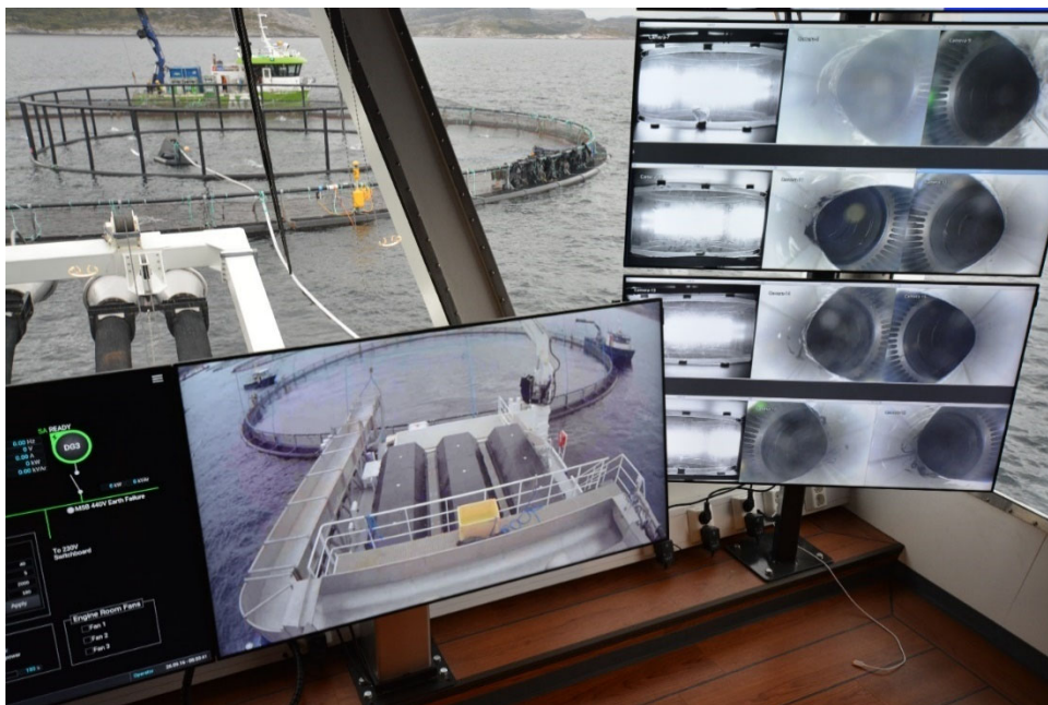
Figur 7 – Kontrollrom på Hydrolicer LG9332 Hydro. Bildet viser merden som fisken skal hentes fra. På dataskjermen midt i bildet ser vi merden avluset fisk skal overføres til (på motsatt side av hydroliceren). Her ser vi også utløpsrennen fisken passerer etter avlusing. De tre sorte enhetene til høyrefor utløpsrennen er trommelfiltere for rensing av prosessvann. Det gule karet, plassert foran rekkverket, er beregnet på fisk tatt ut etter avlusing (Posisjon 2). På dataskjermene til høyre i bildet sees fire enheter for avlusing. Mest framtrødende her er delen med spalter som suger ut vann før reduksjonen i tverrsnitt og tilsatsen av trykksatt vann.
