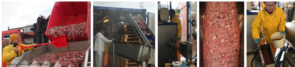
Figur 11. Mating av Mobile Sealab, med tilsetning av antioksidanter etter kverning, før varmeveksler.
