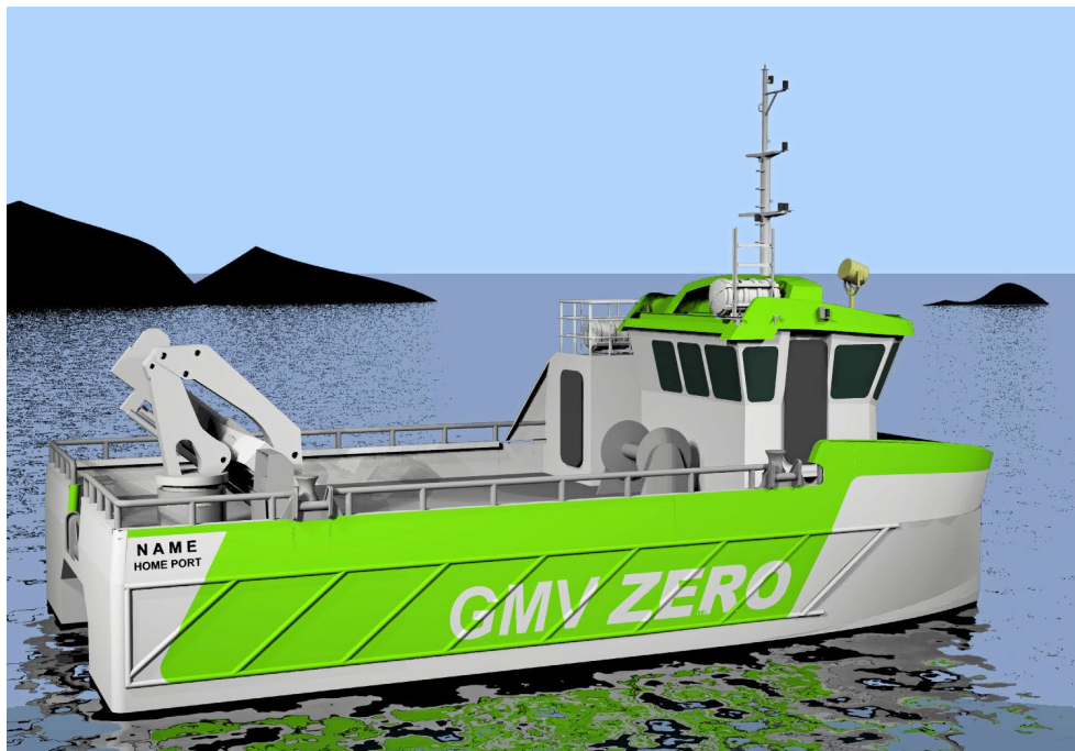
ELEKTRISK: «Astrid Helene» er Grovfjord mekaniske verktøysted AS' første elektrisk drevne røktebåt. ILLUSTRASJON: GROVFJORD MEK. AS
