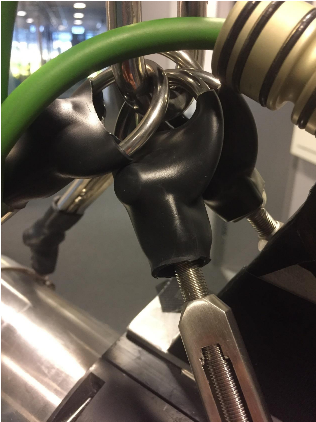
Figur 2: Sammenkobling av ringer (4stk) og sjakkell
