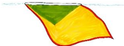
Figur 8: Forslag til risikoklassifiserte sikkerhetssoner ved not. Øverst: Not og sikkerhetssoner i stille vann. Nederst: Not som deformeres i strøm. (Ill.: Heidi Moe Føre og Cecilie Salomonsen, SINTEF Ocean)
