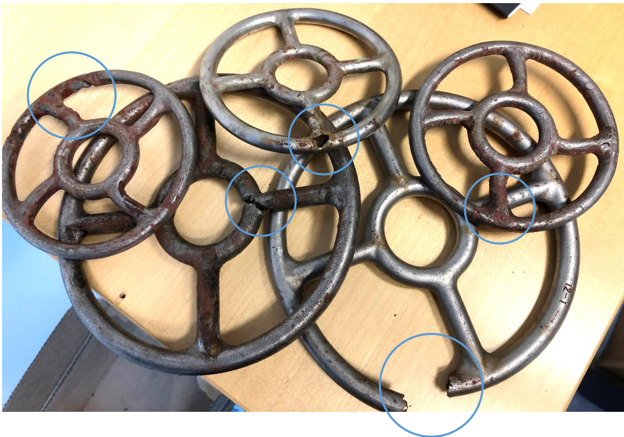
Figur 14: Senterringer og ringer til loddssystem med korrosjonsskader.
