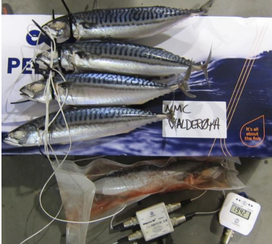
Figur: Comark logger med innstikksfølere (til venstre) og iB Button til høyre.
