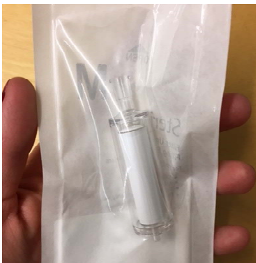
Figur 1: Venstre: Filter som kan fryses ned, måler 6.5x1.5 cm. Høyre: Eksempel på Krona-diagram fra en prøve hos en settefiskprodusent av laks (konfidensielt).
