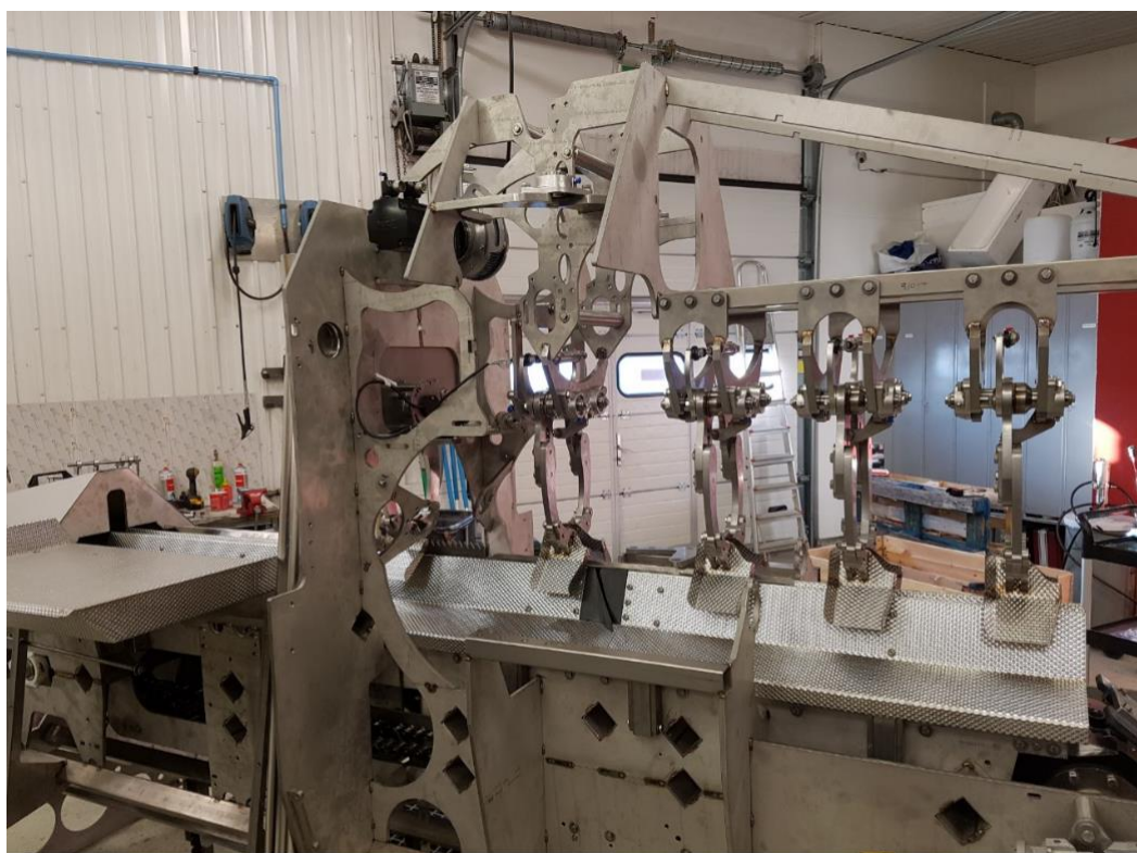
Figur 7. Innmating med sadler, guider for styring av fisk, og svart slisse for kniv.
