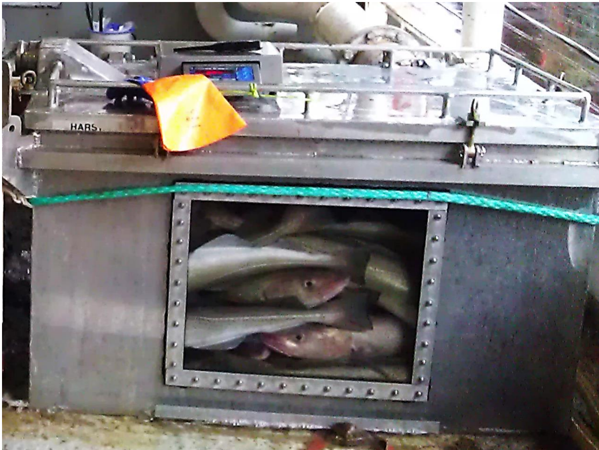
Bilde 2 Viser levendelagring av torsk i 800 liters tanker ombord på M/Tr. J. Bergvoll. Tankene er designet med oppstrøms prinsipp (CRISP Annual Report, 2012; 2013; 2014; Olsen et al., 2014).
