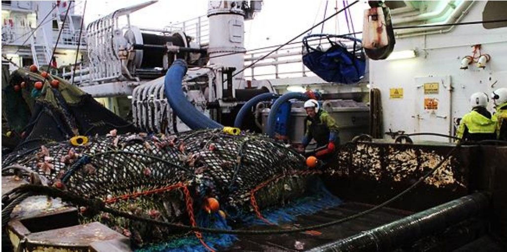
Bilde 5 Viser hvordan fisk fra trålsekken (codend) ble flyttet til tanken for levendelagring. Lukene til mottaksbingene ble åpnet og håven ble lagt ned på steinristen i bakkant av trålsekken. Sekkene ble deretter åpnet og et tilfeldig utvalg av fisk fløt over i håven.
