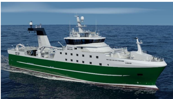
Bilde 3 Til venstre viser fartøyskisse fra Rols Royce som er basert på et standard skrog, 80 meter langt og 17 meter bredt (OPTIPRO 2). Bildet til høyre viser forslag til permanent montering/plassering av pumpe-slange i codend (OPTIPRO 2).
