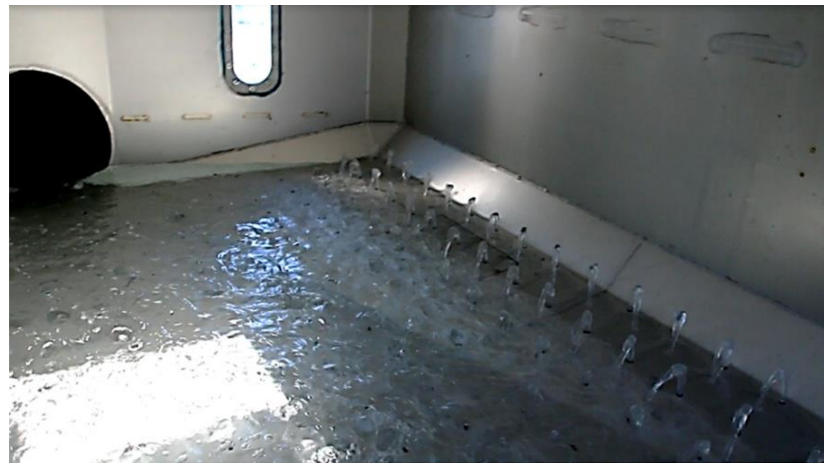
Vannfordelingen (ca. 1000 liter per minutt) opp gjennom den perforerte dobbeltbunnen. Tanken ble fylt i løpet av 4,5 minutter.
