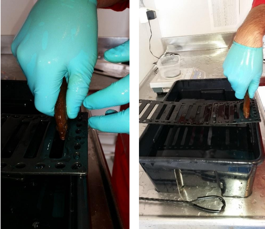
Figur 3. Drop-tester ble utført på bergnebb og grønngylt, som brukes å estimere den maksimale seleksjonen ved 100 % kontaktsannsynlighet med risten.
