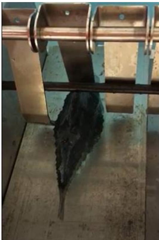
Fig. 18. Rognkjeks eksponert for strøm i tørrbedøver.
