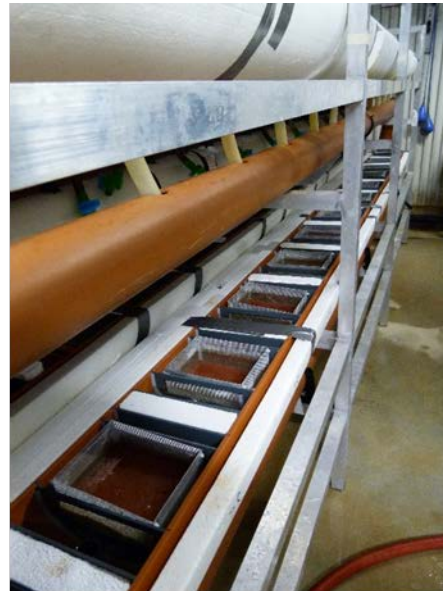
Figur 5 Rogn i perforerte aluminiumsbokser plassert i inkubatorrom med separate inn- og utløp for vann.
