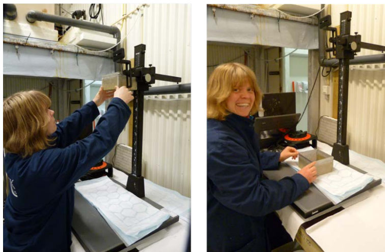
Figur 13 Sjokking av rogn. Bokser med rogn ble sluppet tre ganger fra standardisert høyde (60 cm) ned på benkeplaten på ulike tidspunkt etter befruktning.
