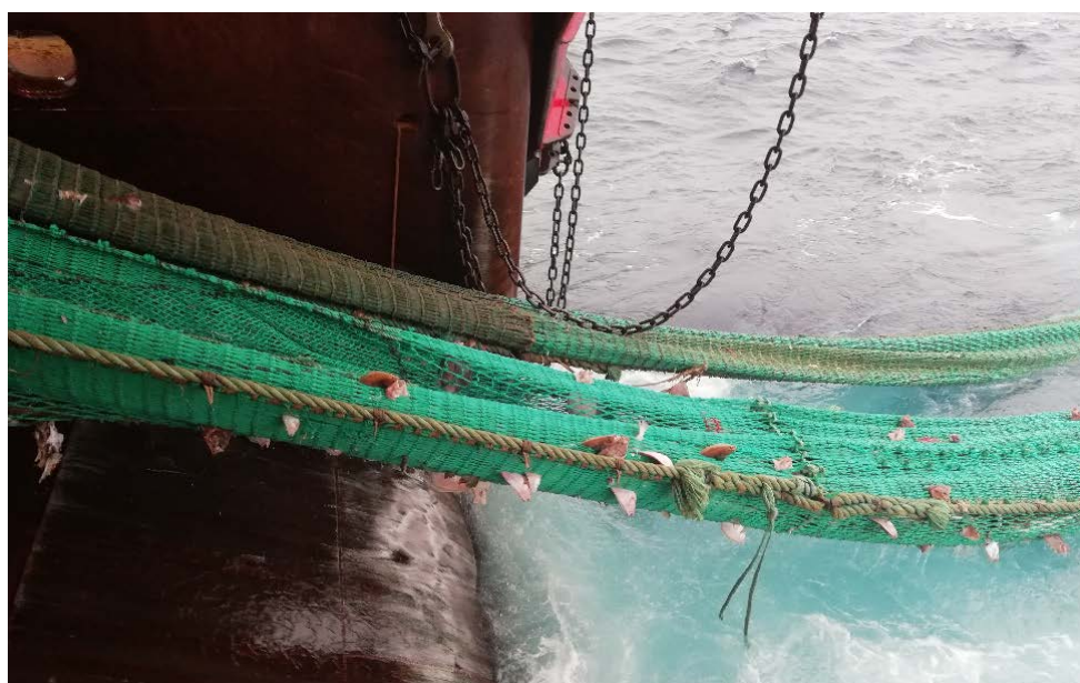
Figur 14. Bildet viser flatfisk som stikker ut gjennom maskene i forlengelsen foran den skånsomme trålsekken (babord), mens ingen fisk stikker ut gjennom maskene i forlengelsen foran den vanlige trålsekken (styrbord).
