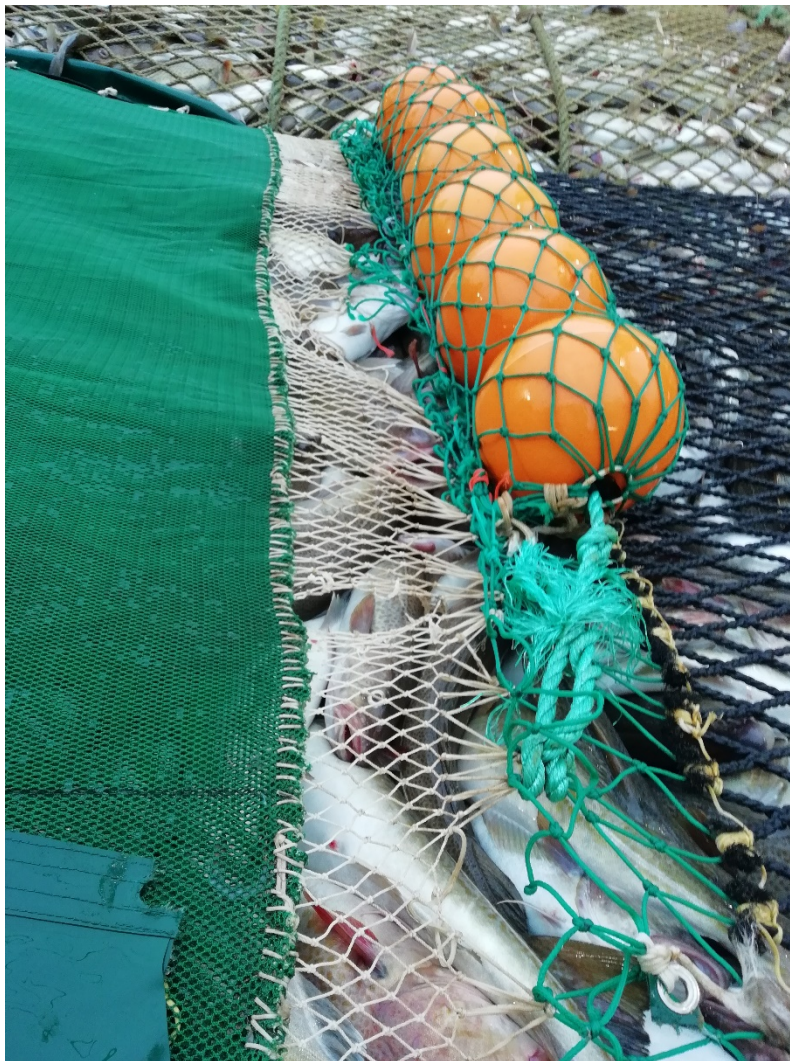
Figur 15. Bilde som viser en av sømmene med tynt lin mellom fremre og bakre del av sekken som revnet etter få tauinger.
