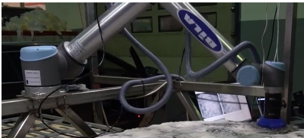
Figur 12 - Bilde av roboten UR - 10 som ble brukt under utprøvingene. Her med sugekopp som gripeverktøy.
