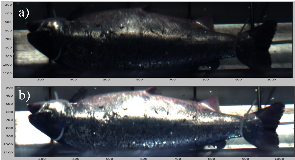
Figur 13. Rå-RGB-bilde av laks med lus. a) viser uten skalering, mens i b) er intensiteten skalert slik at kontrasten blir mer synlig på andre deler av fisken.
